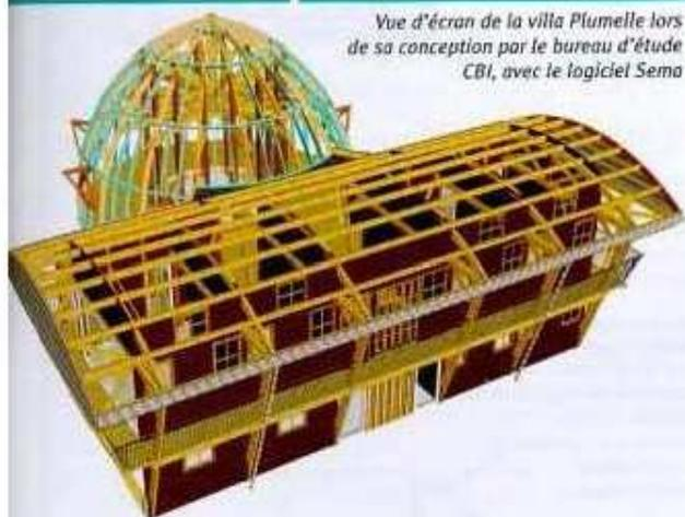
Le programme calcule automatiquement la répartition et positionne les pièces : pannes, chevrons, arêtiers, noues. De la ferme traditionnelle au portique LC, les différentes listes de mètres, de débits, de quincailleries, ect... sont automatiques, ainsi que les fiches de taille pièce par pièce et le transfert aux centres d'usinage.
